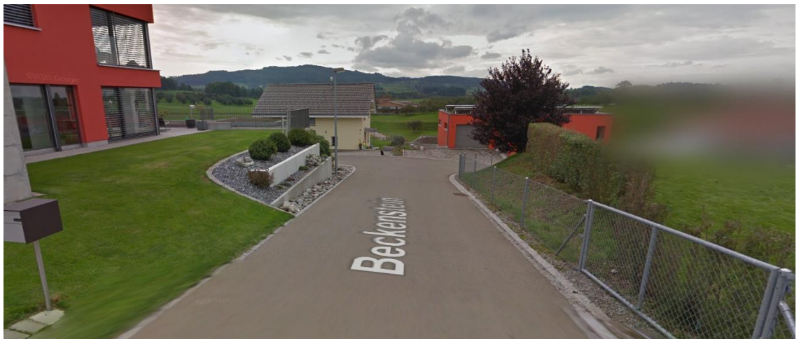
Abbildung 12: Hinterer Beckenstein, geringe Strassenbreite (4.40 m) mit eingeschränkter Kreuzungsmöglichkeit (LW-PW nicht möglich, PW-PW mit reduzierter Geschwindigkeit) (Quelle: Google Street View)
